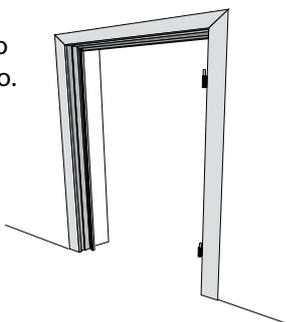
**2** Forare e fissare con viti e tasselli da 6 mm, sui due lati verticali del telaio così come indicato con le lettere a, b, c, d in figura.
