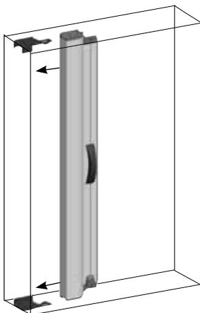
**3** Far scorrere i supporti per cassonetto sulle contropiastre fino ad ottenere lo scatto di blocco. Inserire nel profilo di chiusura i fermaguida, avendo preventivamente controllato la polarità del magnete e quindi definito la posizione dell'alto e del basso. Posizionare il profilo di chiusura sullo stipite opposto al corpo zanzariera. Forare e fissare con le viti e i tasselli in dotazione
