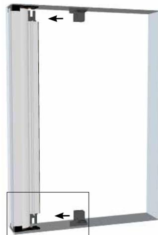
**5** Posizionare il profilo di chiusura sullo stipite opposto al corpo zanzariera. Forare e fissare con le viti e i tasselli in dotazione
