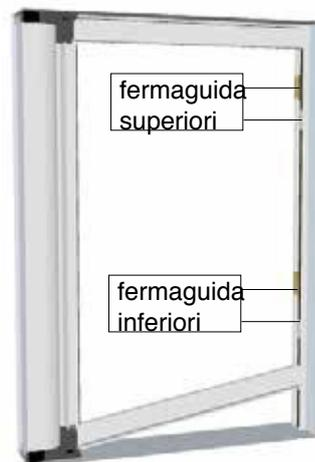
**7** Far scorrere i fermaguida inferiori fino a bloccare la guida inferiore, serrare la vite.
