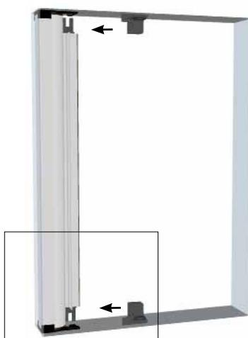
**4** Posizionare il profilo di chiusura sullo stipite opposto al corpo zanzariera, forare e fissare con i tasselli e le viti in dotazione
