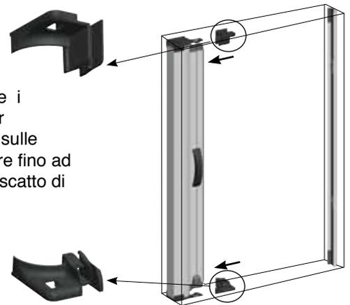
**4** Inserire nel profilo di chiusura i fermaguida, avendo preventivamente controllato la polarità del magnete e quindi definito la posizione dell'alto e del basso. Posizionare il profilo di chiusura sullo stipite opposto al corpo zanzariera. Forare e fissare con le viti e i tasselli in dotazione
