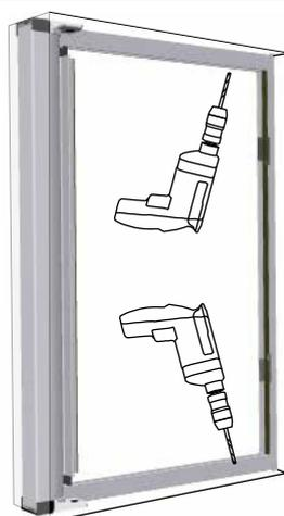
**6** Posizionare a una delle estremità delle due guide gli inviti guida telescopici "e" in cui andrà posizionato il grano nell'apposito foro
