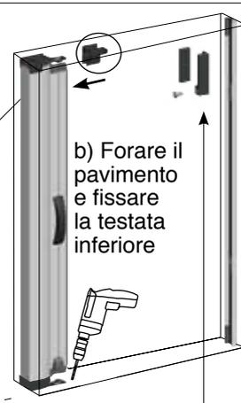
**4** Inserire il compensatore della guida superiore forare e fissare con i tasselli e le viti in dotazione
