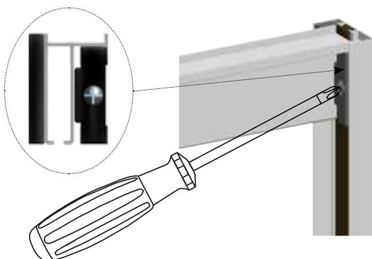
**7** Far scorrere i fermaguida inferiori fino a bloccare la guida inferiore, serrare la vite.
