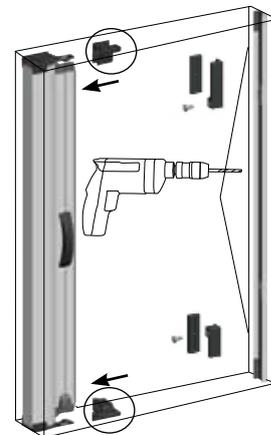
**4** Inserire il compensatore della guida superiore forare e fissare con i tasselli e le viti in dotazione
