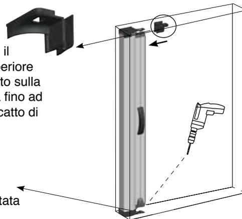
**4** Inserire nel profilo di chiusura il fermaguida, avendo preventivamente controllato la polarità del magnete e quindi definito la posizione dell'alto e del basso. Posizionare il profilo di chiusura sullo stipite opposto al corpo zanzariera. Forare e fissare con le viti e i tasselli in dotazione
