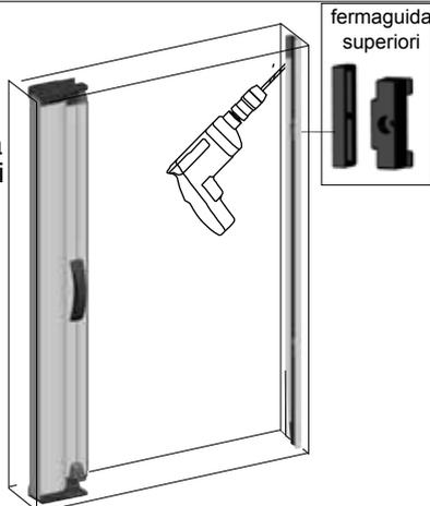
**5** Prima di inserire la guida inferiore, sistemare l'invito guida bassa stondata sulla guida
