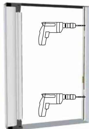
**5** Inserire i compensatori delle guide, superiore e inferiore, forare e fissare con i tasselli e le viti in dotazione
