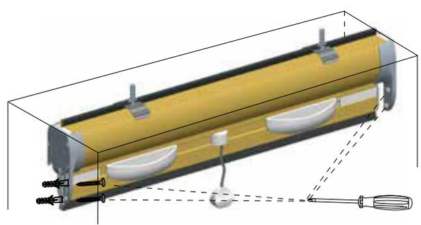
**4** Inserire le guide laterali sotto il cassonetto, negli inviti delle cuffie, forare con punta da 4mm sulle guide a distanza di 10cm dall'estremo inferiore, sfilare le guide, allargare i fori sugli stipiti del vano con punta da 6mm, inserire i tasselli, infilare nuovamente le guide e fissarle con le viti nei fori preventivamente eseguiti.
