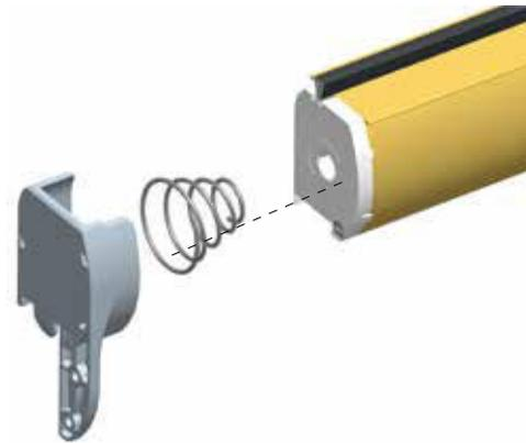
**2** Forare con punta da 6mm il vano superiore così come indicato in figura, mantenendo l'allineamento, posizionare le clip e fissare con le viti.
