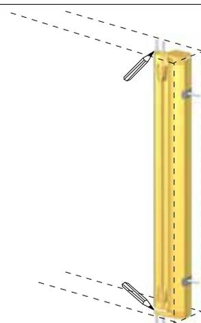
**3** Prima di montare le guide, inserire un fermacricchetto nella guida inferiore e l'altro nella superiore. Infilare le guide negli inviti delle testate cassonetto. Forare e fissare le guide su cui scorrerà la barra maniglia priva di cricchetto.
