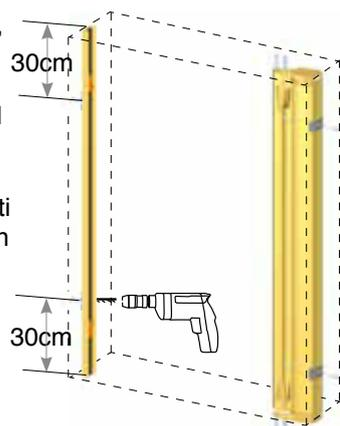
**4** Inserire le guide negli inviti delle testate sul cassonetto e bloccarle con i fermaguida sul profilo di chiusura con viti 3,5x9,5 in dotazione.
