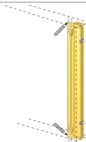
**3** Posizionare il profilo di chiusura laterale, allineato al piano del cassonetto, prestando attenzione alla polarità del magnete, inserire i ferma guida in alto e in basso e bloccare il profilo con le viti e i tasselli come indicato in figura.
