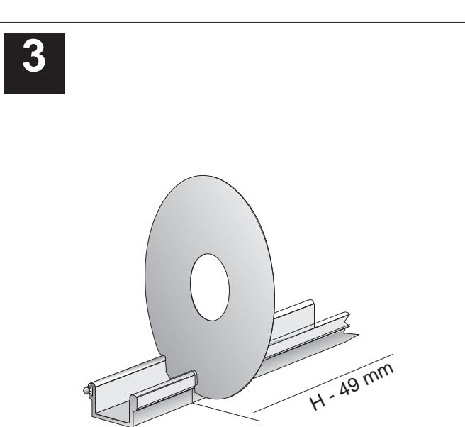
Tagliare il profilo di chiusura di misura pari all'altezza del vano - 49 mm. Cut the fastener profile to the measure of the door space height - 49 mm.
