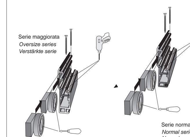
Fissare sull'anta il profilo porta-carrello. Inserire i cuscinetti e bloccarli con l'apposita vite a circa 100 mm dall'estremità del profilo.
