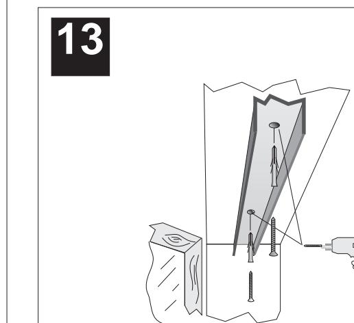
Inserire e fissare il profilo binario nel profilo compensatore.
