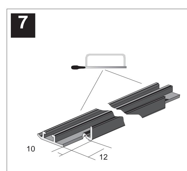
Smussare le estremità del profilo porta-carrello come da figura. Cut the end sides of the bearing housing profile (see figure).
