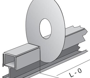
Tagliare i profili compensatore e binario di misura pari alla larghezza del vano. Attenzione: il profilo binario va tagliato da entrambi i lati al fine di mantenere in posizione centrale la predisposizione per l'inserimento dei cuscinetti (fig. 18). Tale predisposizione, di serie nel kit, va effettuata per le barre.
