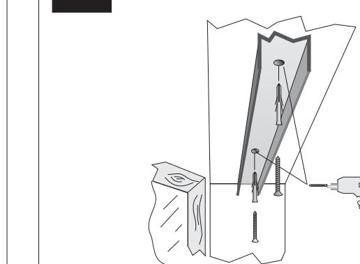
Fissare il profilo compensatore sulla parte superiore del vano.
