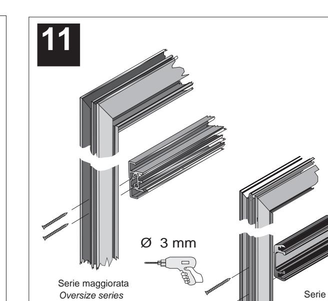
Forare il profilo anta e fissare all'altezza desiderata il profilo traverso. Nella versione maggiorata effettuare i fori con il profilo montato sull'anta.
