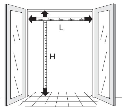
Rilevare le misure di larghezza ed altezza del vano, calcolare la differenza tra le dimensioni della porta e quelle del kit. Tagliare quanto in eccesso.
