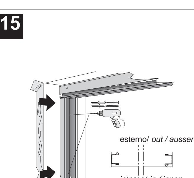
Fissare i profili di chiusura come da figura. Fix the fastener profiles (see figure).
