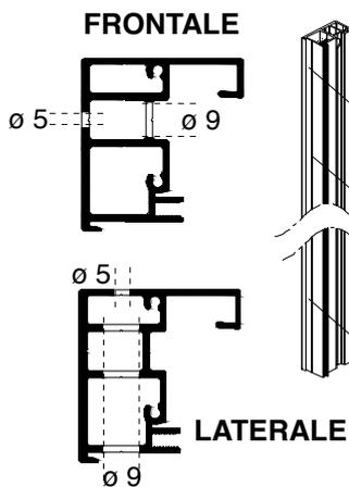
**6** Posizionare il profilo guida, accertandosi che la faccia del profilo "a" sia esattamente collineare alla faccia del profilo "b", segnare i punti dove forare, forare e fissare con viti e tasselli in dotazione
