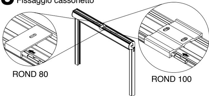
**4** Eseguire tracciatura e foratura per il fissaggio laterale delle piastre
