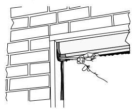
Posizionare il cassonetto nel vano e fissarlo con le viti in dotazione
