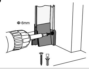
Fissare sul lato del vano il ferma catena a muro
